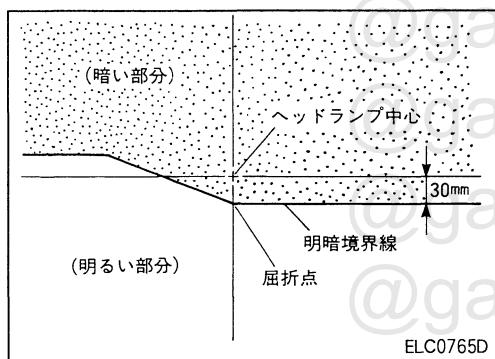
8. 調整用スクリーンに照射されたロービームの明暗境界線を、ヘッドライトのエーミング調整スクリューで、図に示す位置に調整する。
