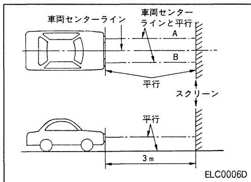
5. 調整用スクリーンとヘッドライトの距離を3m離し、車両とスクリーンを正対（A=B）させる。
