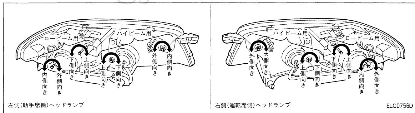
注意：ランプ点灯中はエーミング調整スクリュー以外のランプ各部(金属部分、コントロールユニット、ハーネス、バルブ、ソケット)に手を触れないこと。
